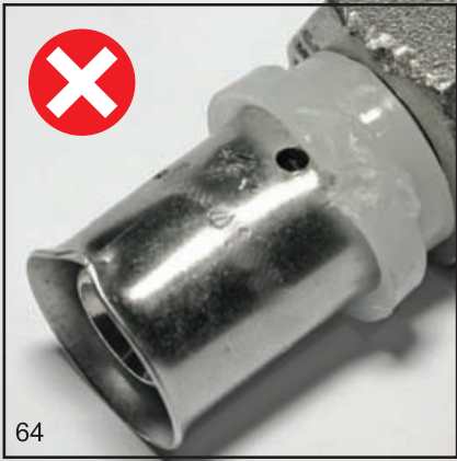
64 При использовании пресс-соединителей необходимо проверить пригодность фитинга к монтажу (фитинг не должен иметь внешних повреждений)
