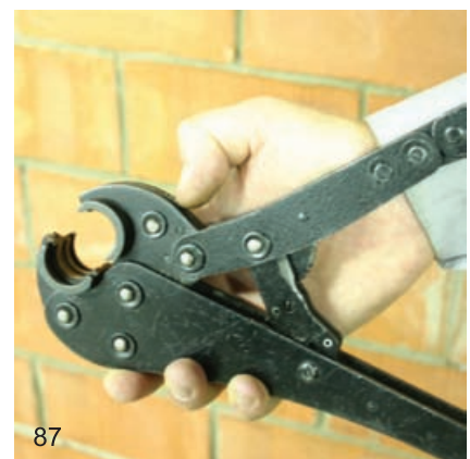
87 Для смены губок такого инструмента, необходимо оттянуть вниз защелку фиксатора на корпусе
