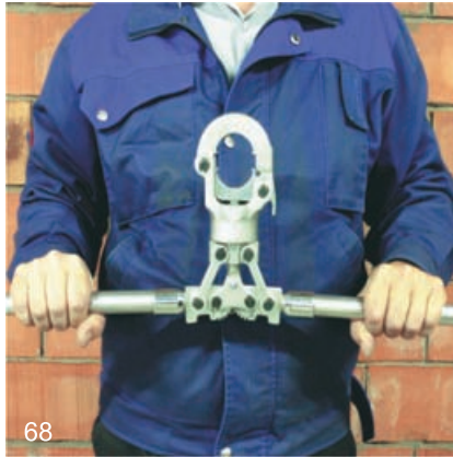
68 При работе ручными пресс-клещами VALTEC придерживаются следующего порядка: – для возможности установки или замены пресс-вкладышей, ручки клещей разводятся на 180°;
