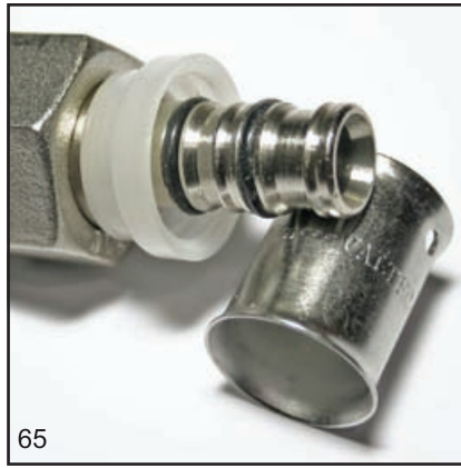
65 При снятой составной гильзе проверяется наличие уплотнительных колец и диэлектрической прокладки.
