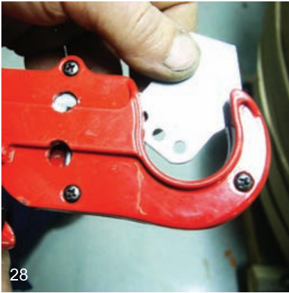
– нож извлекается из корпуса трубореза;
