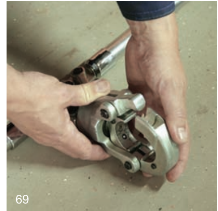
69 – нажатие на рычаг замка приводит к открыванию пресс-обоймы;
