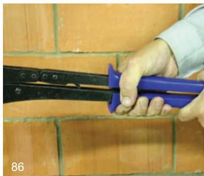
86 Следует, однако, иметь в виду, что такой инструмент не имеет телескопических рукояток. Кроме того для размыкания губок клещей необходимо полностью свести рукоятки друг к другу. Такая конструкция разработана для того, чтобы предотвратить неполную опрессовку
