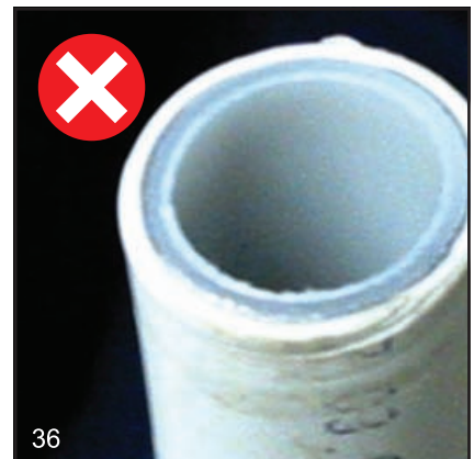
Если труба одета на комбинированный калибратор не до конца, то снятия фаски либо не происходит, либо производится некачественно
