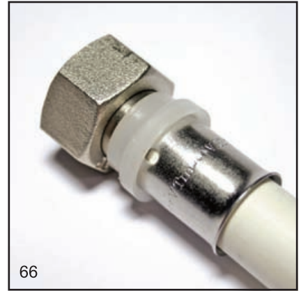
66 Труба надевается на штуцер до тех пор, пока ее не будет видно в круглом отверстии в основании составной гильзы
